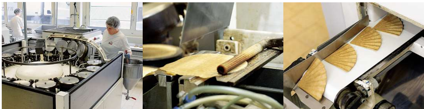
Des méthodes de production exigeantes: la masse de pâte est coulée dans les 18 formes du «carrousel» et chauffée. Dans une deuxième étape de production, les éventails sont pliés deux fois, puis pressés, ce qui leur donne leur forme bien connue.
